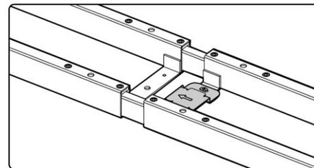
La plaque de fixation peut être fixée à droite ou à gauche.
