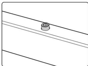
Desserrez les vis à tête hexagonale qui fixent la jonction réglable, mais ne retirez pas complètement les vis.
