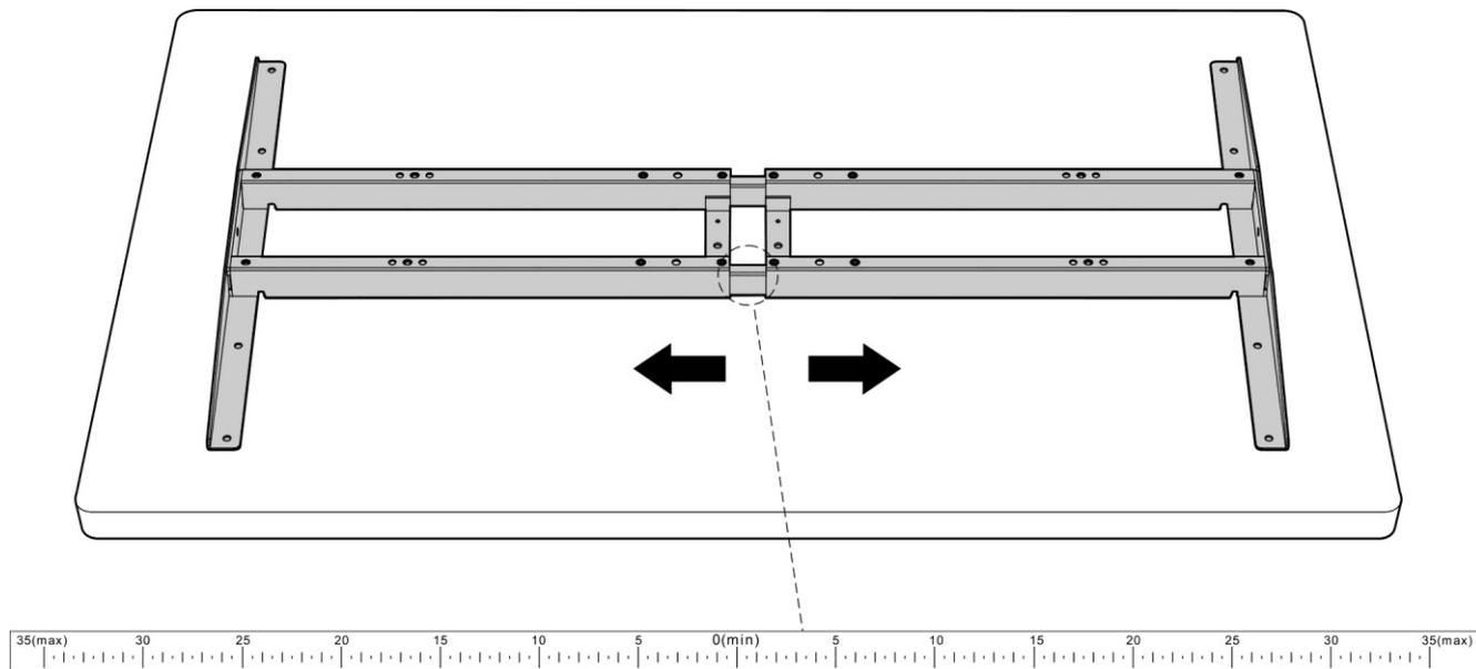
***Lors du réglage de la position du cadre, veillez à ce qu'il ne dépasse pas la plage de réglage imprimée de la barre transversale intérieure.***
